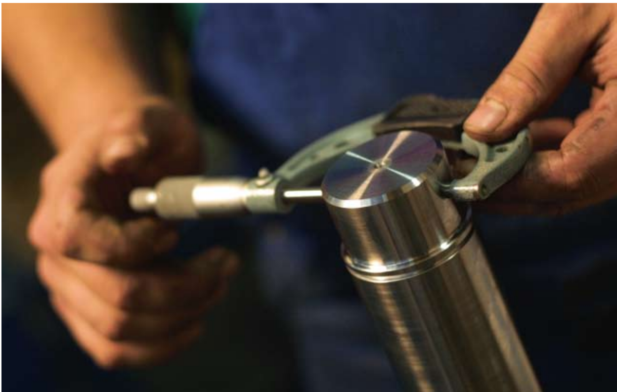
De fintfølede måleredskaber bruges flittigt af medarbejderne i produktionshallen på Bonnet Maskinfabrik. Fabrikkenes computerstyrede maskiner kan programmeres med nøjagtigheder helt ned til 1/1000 millimeter. Foto: Bonnet Maskinfabrik.
